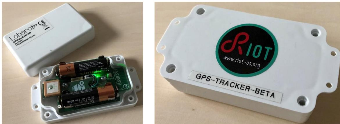
**Figure 97: RIOT - LoRaWAN GPS Trackers**
